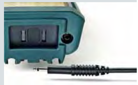
Anschluss für externes Netzteil und batterieunabhängige Dauerversorgung
