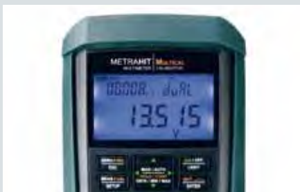
Displaybeleuchtung und Mehrfachdisplay z.B. Funktionen und Ausgabewert oder Mess- und Simulationswert etc.
